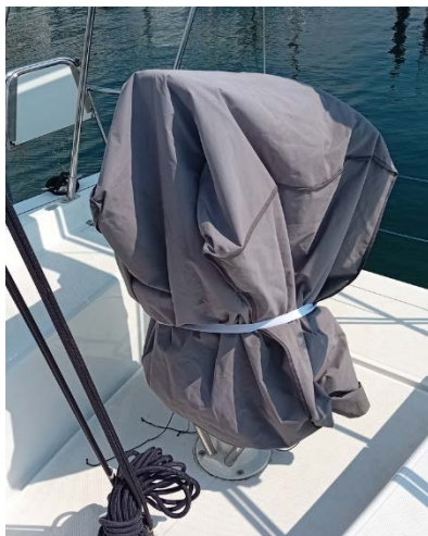
Steuerrad mit Persenning abdecken und mit Band sichern.
