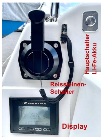
Bild A+B: im Cockpit achtern bb: Leistungshebel in Neutralstellung, Hauptschalter für die Motorenbatterie (Li-Fe-Akku), Reissleinenschalter (Magnetkopf unterhalb des Leistungshebels, mit Leine fixiert). Betriebsdisplay: links mit Deckel; rechts offen
