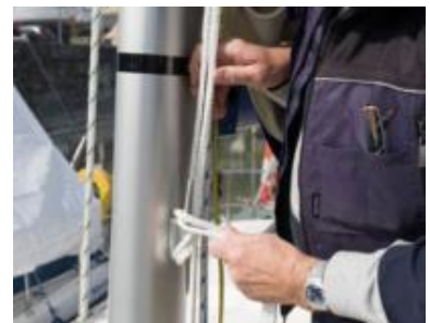
12. Weiße Leine an Klampe am Mast befestigen.
