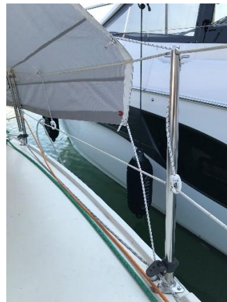
Bild 16: Gummibänder an der unteren Reling-Leine mit Haken einhängen
