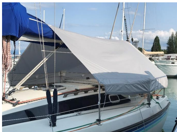
Bild 18: Sauber montierte Persenning
