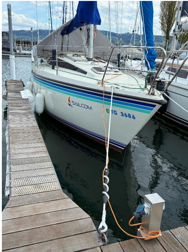
Bild 21: Führung Stromkabel und Landsteckdose
