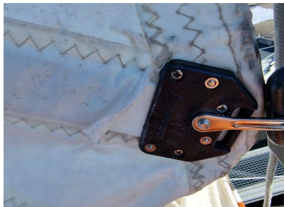
Segellatte in die Halterung einschieben
