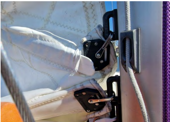
Falsch: die Segeltasche ist bereits ausgerissen
