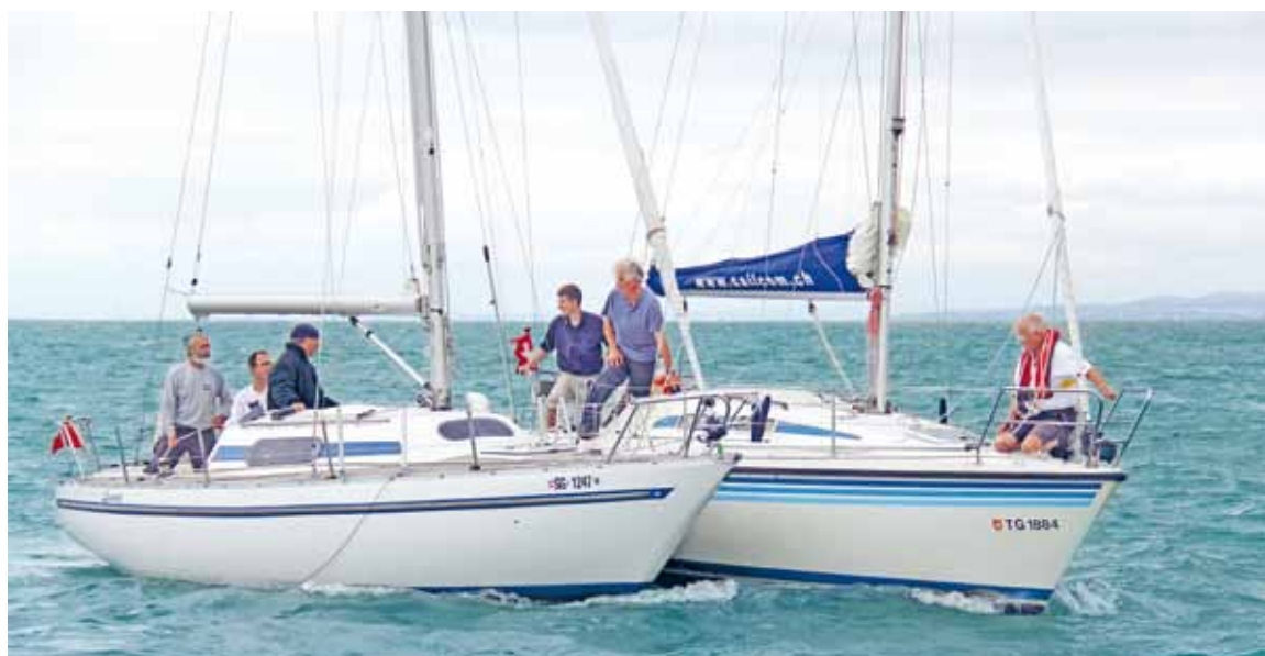
Der Schlepper (links) macht 1/3 Bootslänge hinter dem Havaristen seitlich fest. Mit einer Bug-zu-Bug-Leine wird die Ausrichtung der Boote vom Schlepper-Cockpit aus gesteuert.
