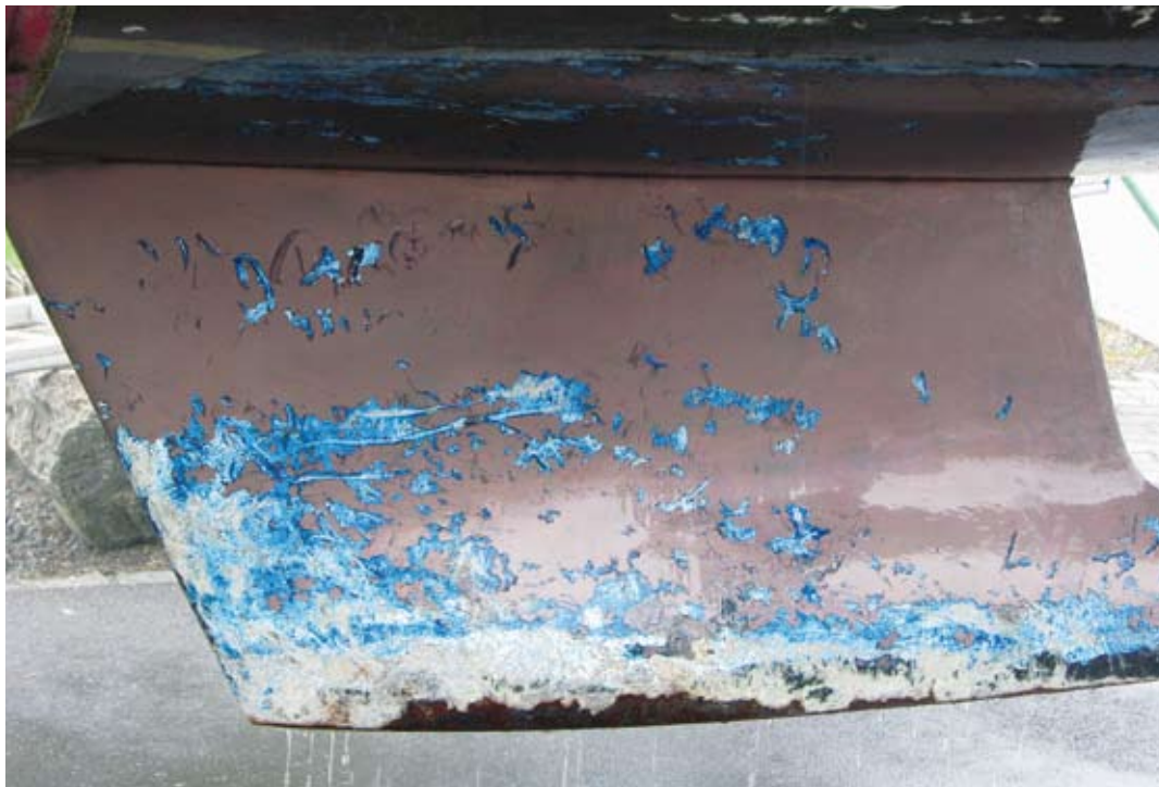
Kielschaden nach Grundberührung.
