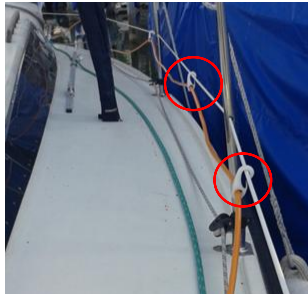
Bild 40: Landstromkabel mit Aufhänge-Hacken
