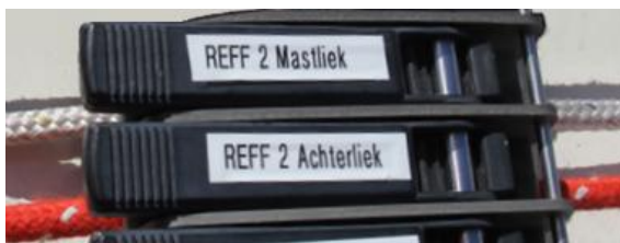
Bild 2: Reff-2 Leinen sind Backbord belegt
