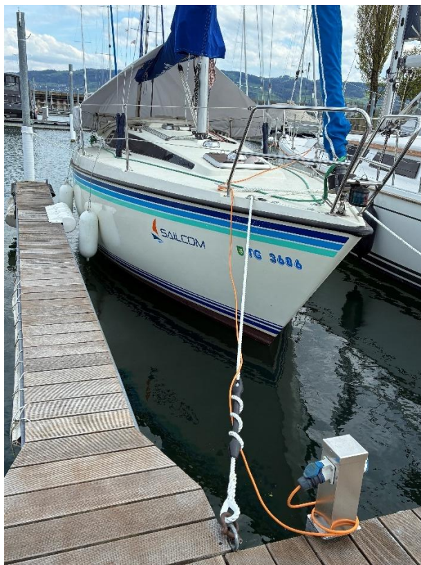
Bild 21 : Führung Stromkabel und Landsteckdose
