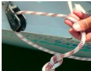
8. Schoten am Heck durch den Block ins Cockpit führen. Lee-Schot auf Winsch belegen
