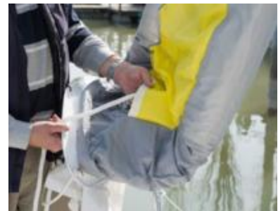
9. An der weissen Leine Bergeschlauch nach oben ziehen.
