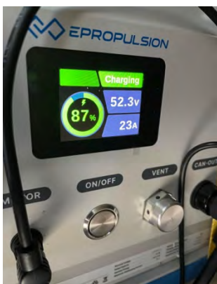
1. Batterie einschalten (ON/OFF 5 Sekunden drücken)
