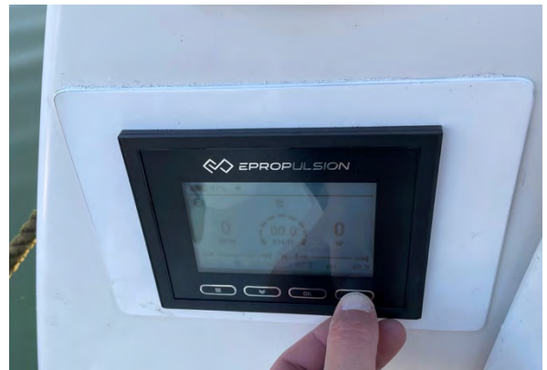
Display zu Batteriestand ist hinter der Abdeckung. 3 Sekunden rechts aussen drücken.
