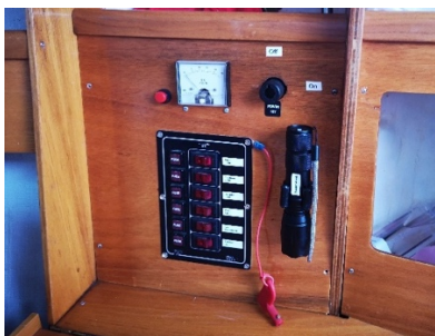
Bordelektrik für Lichter und 12V Steckdose, USB-Lademöglichkeit unter der Abdeckklappe
