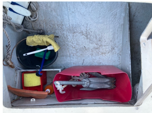
Inhalt stb Backskiste: Leinen, Fender, Pütz, Putzmaterial, «Rettungsring» mit Wurfleine, Heckanker
