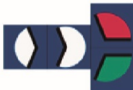
Besser sichtbar unter Motor: "Seiten- und Hecklicht" und "Dampferlicht"
