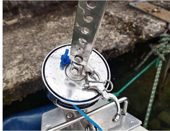
Rolltrommel mit Schnapp-Schängel für Genua-Hals. Mit der blauen Rolleine lässt sich das Vorsegel einrollen.
