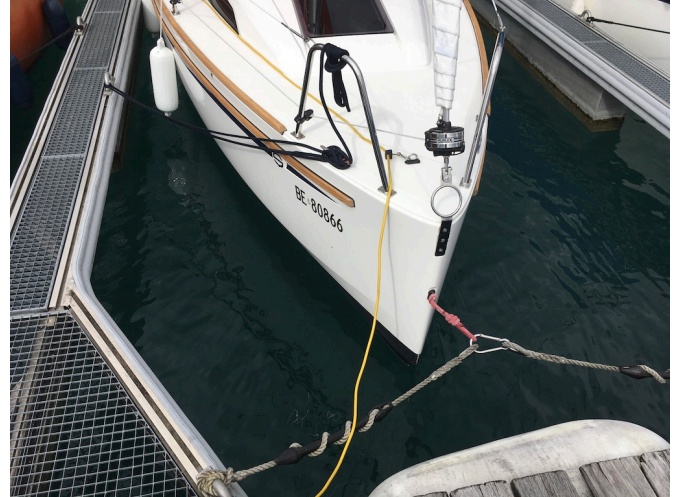
2. Bugleine, Vorspring, Landstromkabel
