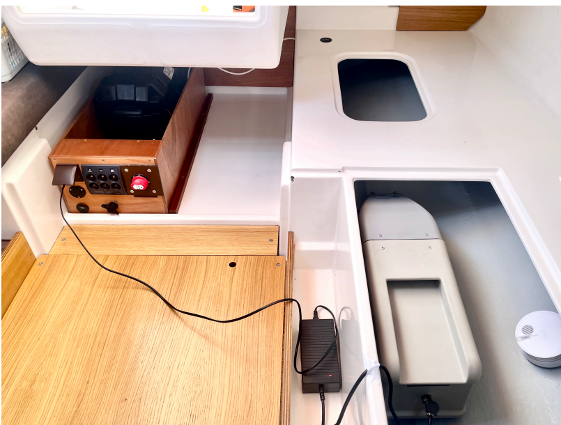
6. Anschluss des Ladegeräts für die Li-Jon-Batterie (= Motoren-Akku) an den 230V-Stecker (nur am Landstrom)
