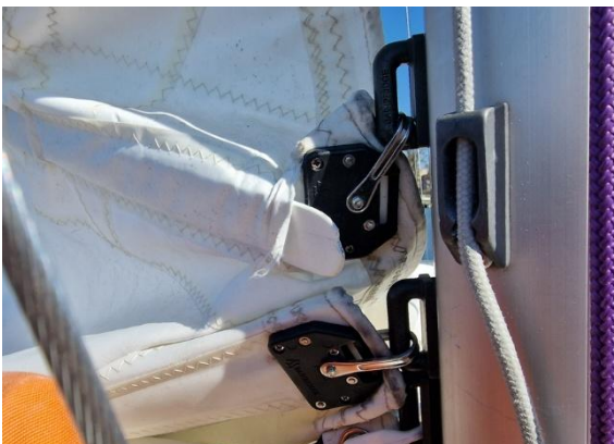
Falsch: die Segeltasche ist bereits ausgerissen
