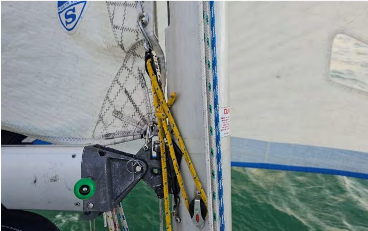
Cunningham (gelb-blaue Leine) mit Haken in unterster Kausch im Grossegel. Zum Reffen den Haken in entsprechende Reffkausch einhängen.
