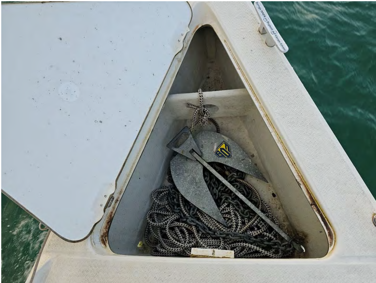
Anker mit ca. 3m Kette und 20m Ankerleine.
