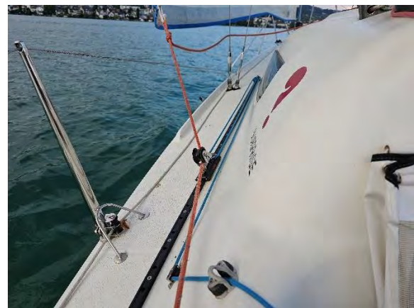
Mit den blauen Leinen auf bb und stb lassen sich die Holepunkte für die Genuaschot einstellen.
