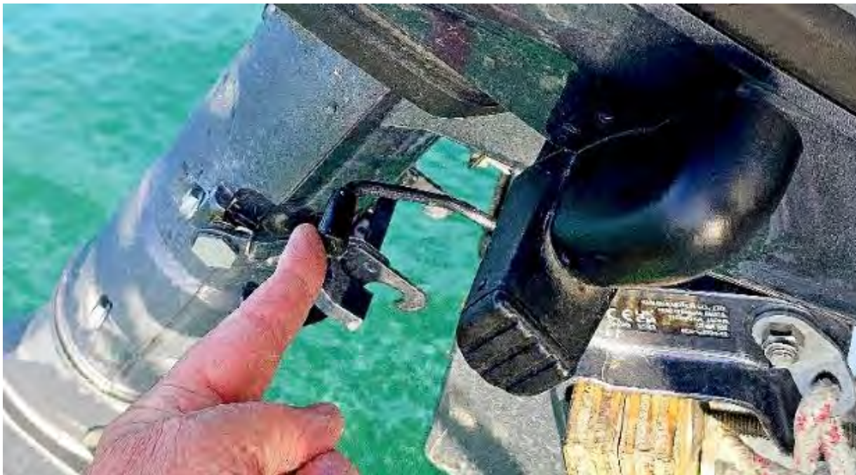
Position des Entriegelungshebels zum Zurückkippen des Motors.
