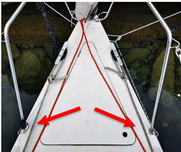
Alle vier Festmacher an den Vorderklampen. Weisse Springs «innen» am Bugkorb auf die Klampen führen!
