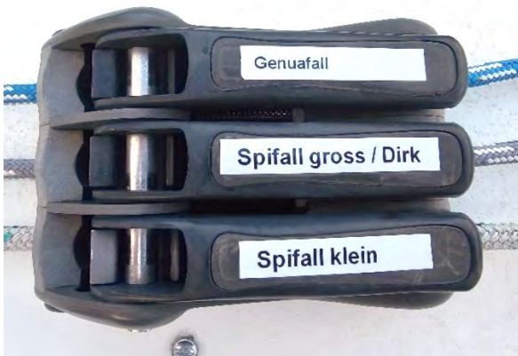
Genuafall, Spifall gross (aktuell hauptsächlich als Dirk verwendet) und Spifall klein sind auf bb.
