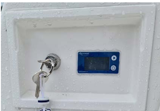
Schlüsselschalter und Anzeige ladezustand
