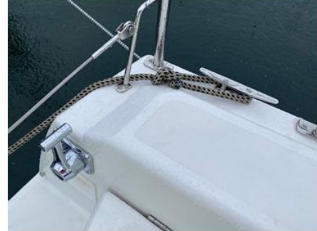
Backbord Heckfestmacher zum Schutz des Motorhebels durch Relingstange belegen
