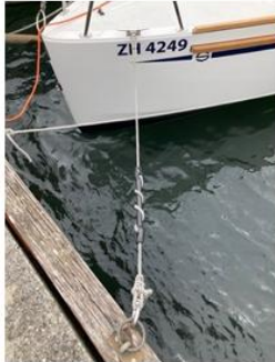
Bug-Festmacher Elektrokabel mit Lose (slack)
