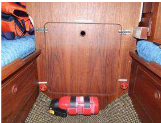
Rettungswesten in der Hundekoje auf stb, Feuerlöscher und die 2 roten Lenzventile (immer offenlassen!) unter dem Niedergang.
