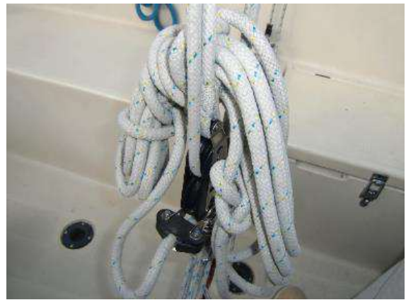
Grossschot so in Talje legen, dass sie nicht nach unten aus der Klemme rutschen kann.
