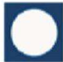
Vor Anker und erlaubt unter Segeln und Motor: weisses "Rundum-/ Ankerlicht"
