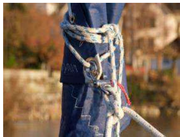
Eingerolltes Vorsegel am Schothorn mit Sicherungsbändsel zusammenbinden, um unbeabsichtigtes Öffnen zu verhindern.
