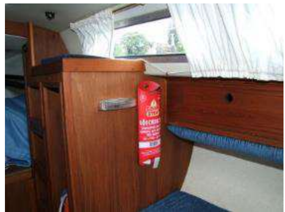
Feuerlöschdecke am Kleiderschrank auf stb.
